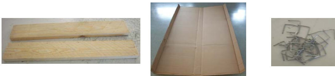
Figura 6 Materiales utilizados para las distintas caras del envase de las hojas de cabina y para su
