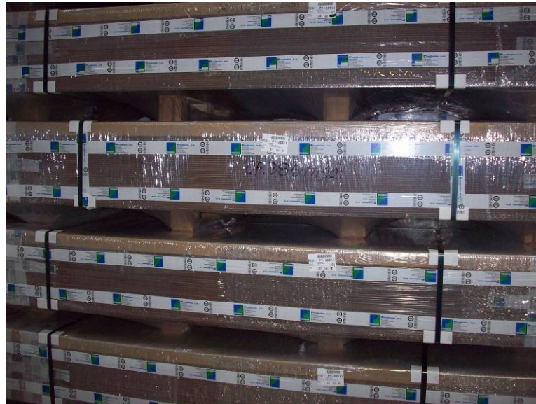
Figura 2: Sistema de embalaje utilizado por PRODEMA, S.A para laminados compactos de madera.
