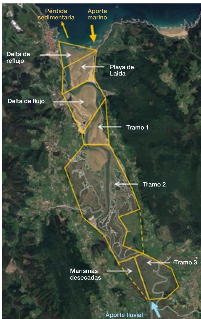
Figura 19. Definición de los distintos tramos del estuario del Oka implementados en el modelo ASMITA y esquema de las interconexiones entre los elementos en el modelo.
