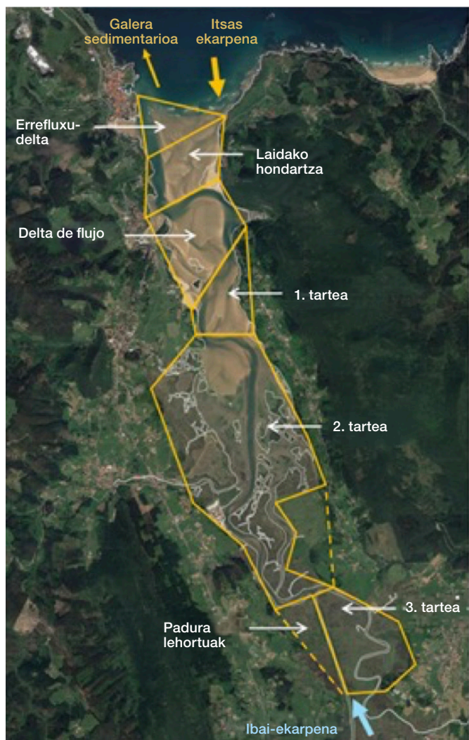
19. irudia. ASMITA ereduaren inplementatutako Oka ibaiaren estuarioaren tarteen definizioa eta eredu elementuen arteko interkonexioen eskema.
